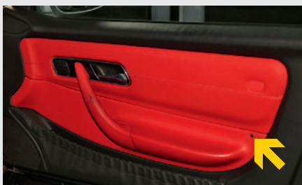
Die Türverkleidungen lösen sich gern. Solche Schrauben gab es ab Werk nicht!
