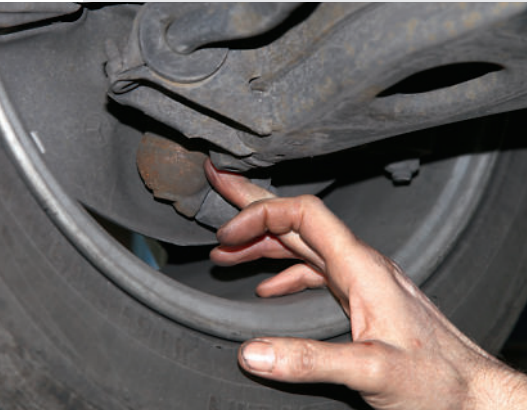
Die vorderen Tragarmgelenke sind nicht sehr langlebig und neigen zum Klappern
