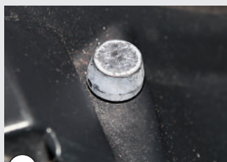
2 Die unscheinbaren Puffer im Kofferraum halten das geöffnete Dach. Sie verschleßen unmerklich
