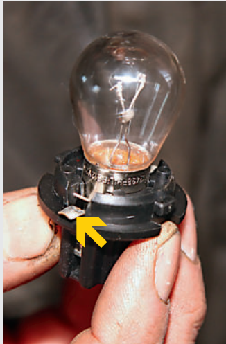
Daimler-typisch: Verbrannte Kontakte an den Steckfassungen
