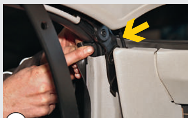
6 Nach häufigem Gebrauch können die Kabel an dieser Stelle brechen. Die Gelenke verlangen nach Schmierung
