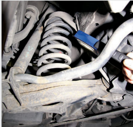
Die untersten Federwindungen brechen in ihren Aufnahmen am Querlenker
