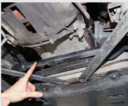
Der Lenkungsdämpfer wird schwergängig und beeinträchtigt das Rückstellmoment
