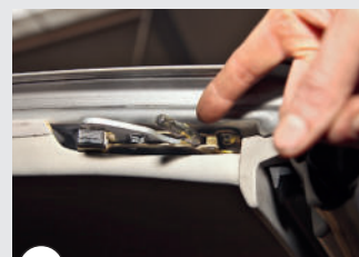
4 ...neigen zu Ausfällen und Wackelkontakten. Dann lässt sich das Dach nicht mehr öffnen
