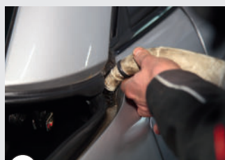
13 Wasser, das hier eintritt, muss im Bereich des hinteren Stoßfängers ungestört ablaufen
