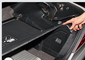
3 Die Mikroschalter des Rollos im Kofferraum und am vorderen Schließmechanismus...
