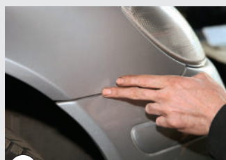
11 Der Übergang zwischen Vorderkotflügel und Stoßfänger gehört zu den wenigen Rostecken
