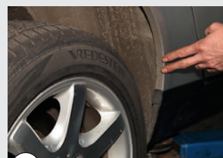
10 Die Radläufe rosten vor allem, wenn der Lack zuvor durch Steinschlag beschädigt wurde
