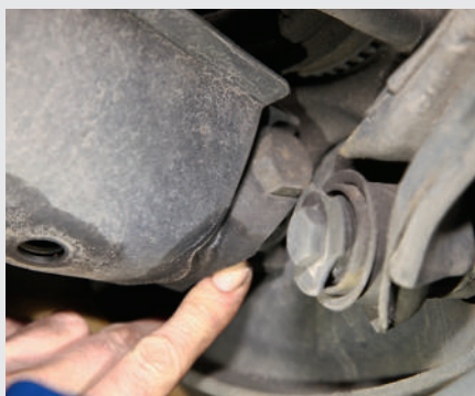
Knarrt es an der Hinterachse, ist oft die Buchse unten am Achsschenkel festgegemelt
