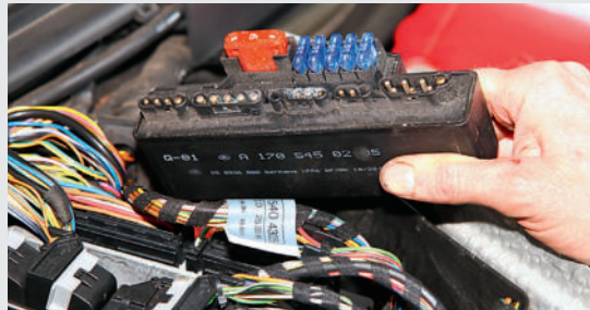
Das K40-Relais fällt altersbedingt aus. Es sollte nach 15 Jahren vorsorglich gegen ein Neuteil getauscht werden
