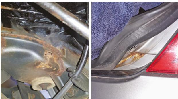
**Auf mangelhafte Vorsorge bei der Produktion deuten frühzeitig durchgerostete Hinterachsträger (l.). Eine weniger dramatische Problemzone findet sich unter dem Dichtgummi am Heck (r.)**
