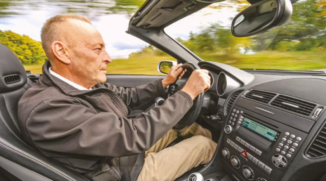
**Gewöhnungsbedürftige Nähe:** Es ist der Dachkonstruktion geschuldet, dass die stark geneigte Windschutzscheibe sehr weit über den Innenraum ragt. An kühlen Tagen erfreuen die *Aircarf*-Warmluftdüsen in den Kopfstützen
