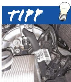
**Das Ölstoppkabel, erkennbar am weißen oder grünen Fähnchen, sollte am Nockenwellensteller montiert sein**
