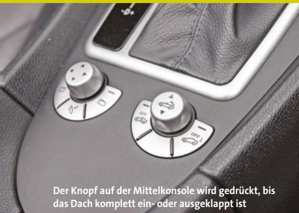
Der Knopf auf der Mittelkonsole wird gedrückt, bis das Dach komplett ein- oder ausgeklappt ist
