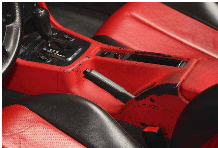
Schon mit dem bloßen Fingernagel lässt sich der Softlack leicht abkratzen (großes Bild links). An besonders belasteten Stellen ist das schwarze...
