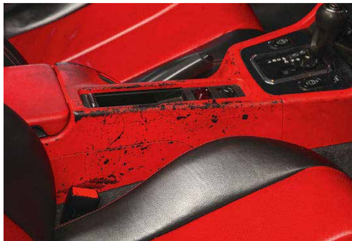
...Kunststoff-Trägermaterial großflächig zu sehen. Mit Austupfen allein lässt sich hier keine einheitliche Oberfläche mehr erzeugen
