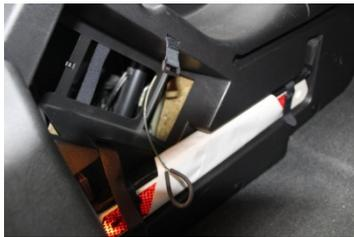
Die Seile links und rechts zur Entriegelung der Schlösser befinden sich hinter der Verkleidung.
