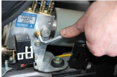
Mit dem Imbusschlüssel dreht ihr die Ventilverschlusschraube (Messing) bis zum Anschlag auf.
