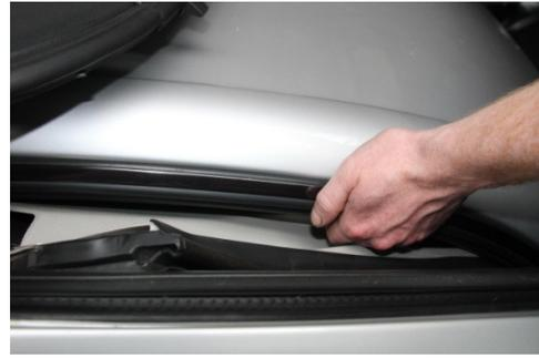
**(Achtung! Die Finger nicht zu weit unter das Dach - Einklemmgefahr)** Achtet darauf, dass weder die Hutablage noch der Kofferraumdeckel das Variodach berühren.
