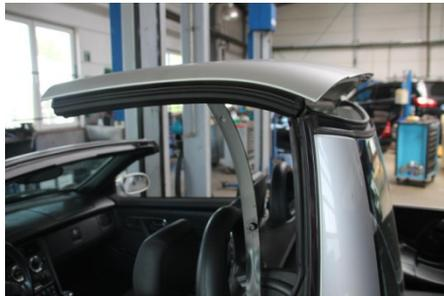
Steht das Variodach im 90° Winkel, hält eine Person es in dieser Position und der andere öffnet den runden Deckel am Dachhimmel. Mit dem Imbusschlüssel dreht er die Spanschlösser auf (90° im Uhrzeigersinn).
