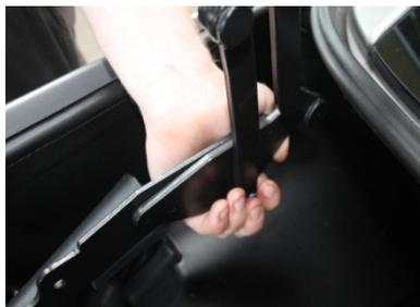
Beide Personen ziehen an den Seilen und heben gleichzeitig das Gestänge (siehe Bild links) ca. 5cm nach oben. Dadurch rastet das Gestänge nicht wieder in die Schlösser ein. Anschließend schließt ihr den Heckdeckel vorsichtig bis er ins Schloss einrastet.
