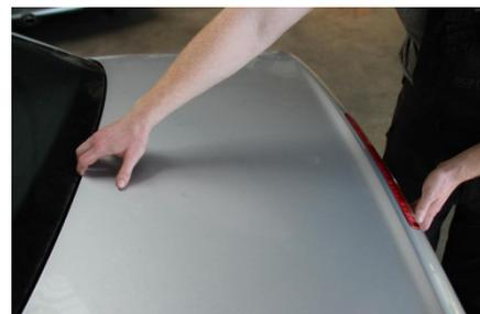
Eine Person steht auf der linken Seite und die andere auf der rechten Seite vom Kofferraum. Beide Personen greifen mit der Hand unter die Dichtung vom Variodach (siehe Bild rechts). Nun hebt ihr vorsichtig das Variodach aus dem Kofferraum.
