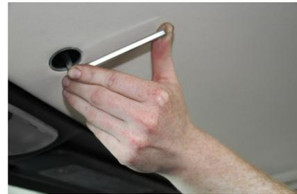
Jetzt legt ihr vorsichtig das Variodach mit den Zapfen in die Führung ab. Dreht mit dem Imbusschlüssel die Spanschlösser (Dachhimmel) ca. 90° gegen den Uhrzeigersinn bis zum Anschlag. Jetzt ist das Dach verriegelt. Schließt beide Seitenscheiben.
